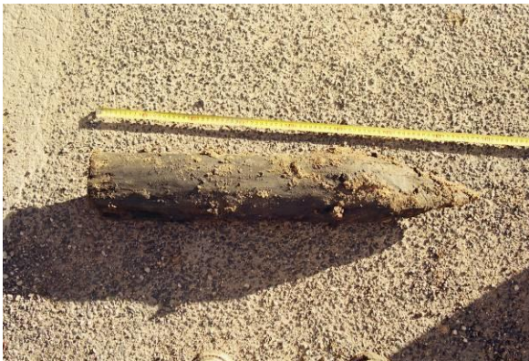
Figs. 83 e 84 – Estacas de pinho retiradas de sob o muro de delimitação da vala.
