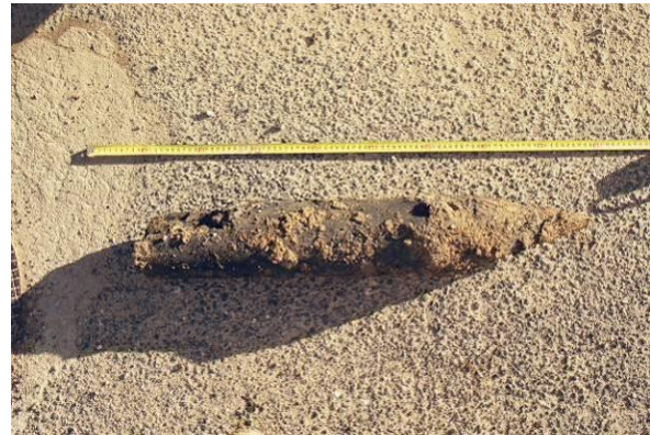
Figs. 83 e 84 – Estacas de pinho retiradas de sob o muro de delimitação da vala.
